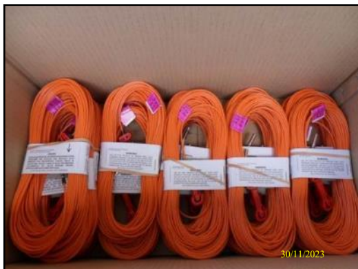
ภาพที่ 2.18 การใช้แท่งป่วงเวลาเพื่อควบคุมปริมาณวัตถุระเบิดต่อจังหวะการระเบิด ให้มีค่าน้อยกว่า 650 กิโลกรัม/จังหวะถ่วง
