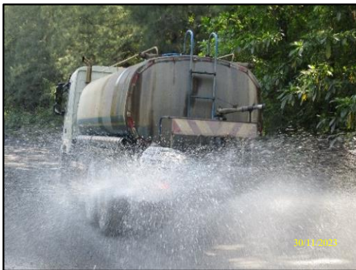
ภาพที่ 2.26 รถบรรทุกฉีดพรมน้ำบนถนนที่ใช้ขนส่งแร่หินปูนตลอดช่วงการทำงาน
