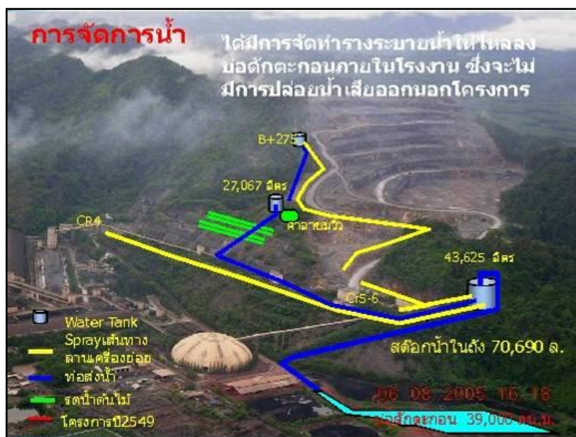
ภาพที่ 2.9 การออกแบบหน้าเหมืองให้มีการไหลของทางน้ำลงสู่บ่อตกตะกอนของโครงการ
